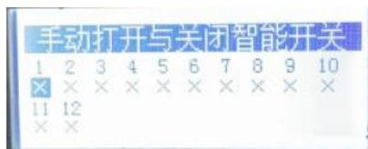
1.2 按菜单（ENTER）选择路数，按向上键（UP）键或向下键（DOWN）键设置开关状态，√进入通电状态，×进入关电状态
